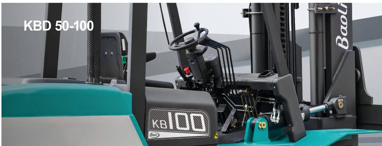
I modelli KBD 50- 100 sono disponibili con capacità di carico di 5,0, 6,0, 7,0 e 10,0 tonnellate con baricentro di 600 mm. Sono dotati di potenti motori HDI EU5 per i mercati con requisiti di conformità CE e di motori Weichai e Isuzu per i mercati in cui la conformità CE non è richiesta. Si tratta di mezzi semplici, affidabili e di facile manutenzione, progettati per applicazioni gravose.
